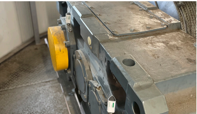
OPTIME Sensoren überwachen im High Dynamic Mode Motor und Getriebe
