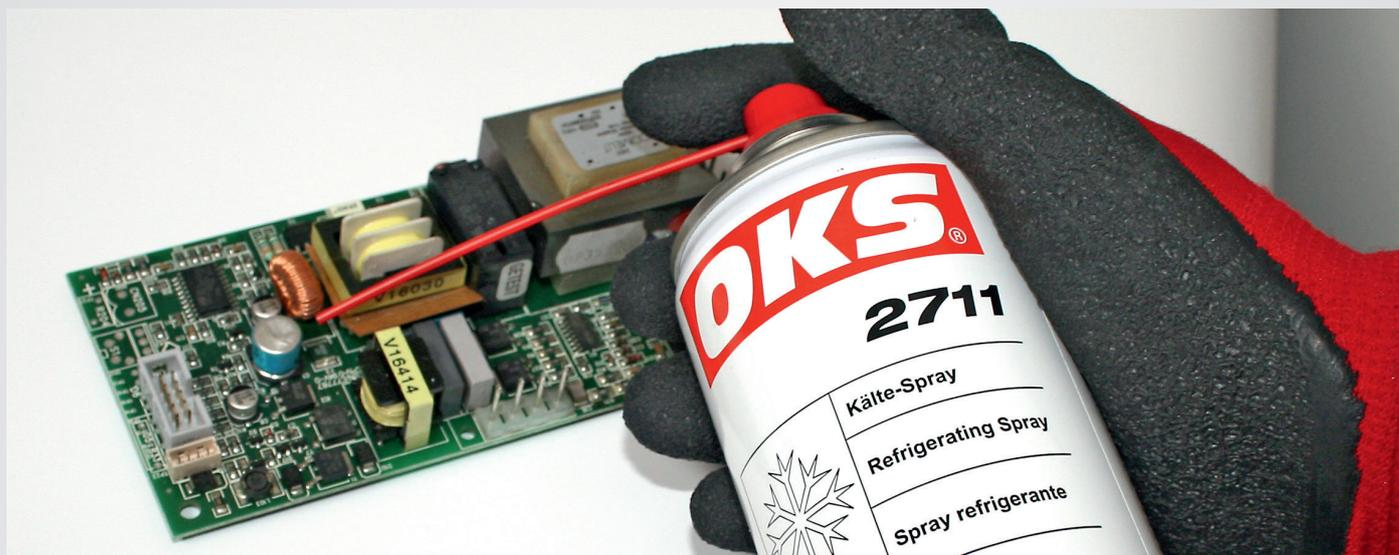
**Kälte-Spray zur raschen Feststellung thermisch bedingter Unterbrechungen in elektrischen Schaltungen oder Bauelementen.**
